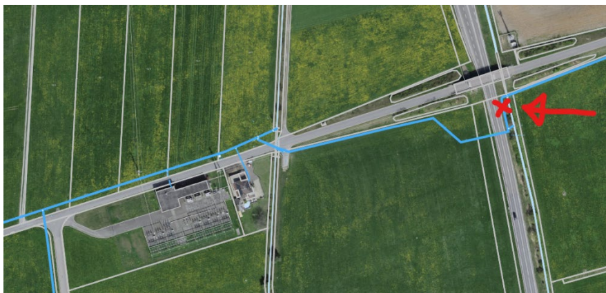
Grafik: Situationsplan der betroffenen Verbindungsleitung Niederurnen–Weesen mit der Leckstelle beim Birchgraben.
